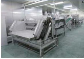
解凍後、タンクを上げ機に移動し、水を切り搬送コンベアにて原料を水圧ウロコ取り機へ送ります。
