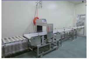
バック室よりローラーで搬送します。さらに金属探知機を通し、二度目の危害チェックを行います。
