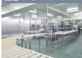
整形コンベアにて処理された魚をトンネルフリーザーに送ります。
