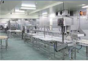
下の段より処理された魚を流し、最終整形し上の段のコンベアより次の作業工程に送ります。
