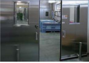
フロア（エア）解凍設備を完備。タイマー設定により、原料に負担をかけずに解凍する事が出来ます。一度に1.5tの解凍処理能力が有ります。
