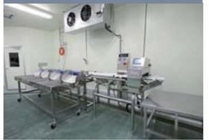
凍結された製品を金属探知機を通し、5種類の重量設定されたポケットに自動的に流します。重量設定は1g単位で可能です。
