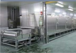
高性能トンネルフリーザーです。-40℃まで冷やし込み可能で、14mかけて急速に凍結していきます。1時間に500kgの凍結も可能です。
